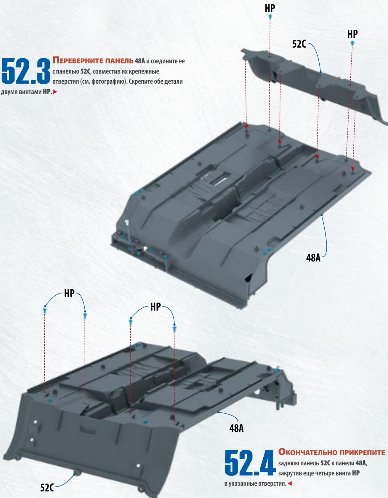
**52.4** ОКОНЧАТЕЛЬНО ПРИКРЕПИТЕ заднюю панель 52С к панели 48А, закрутив еще четыре винта НР в указанные отверстия. ◀
